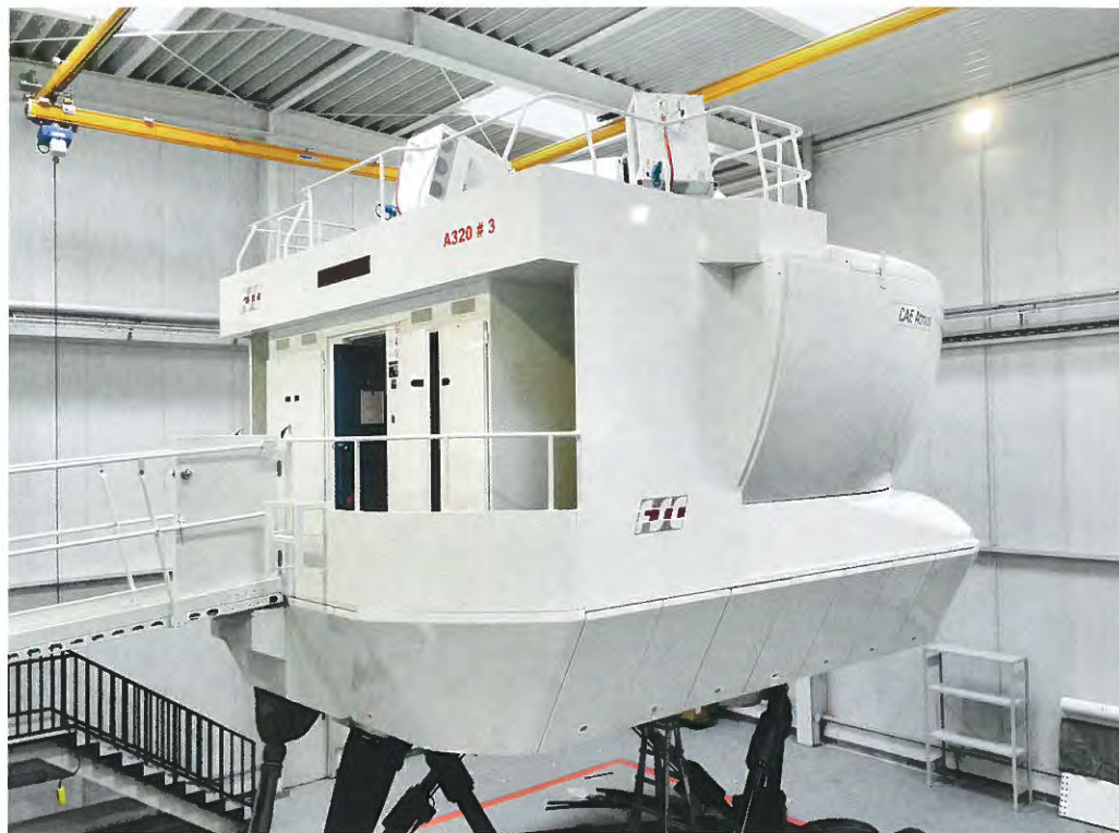
Moderner Simulator: Der CAE 7000, auf dem RWL das A320-Training anbietet, wird komplett elektrisch bewegt und verbraucht 80 Prozent weniger Strom als frühere Generationen
